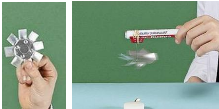
Figure 1. Gauche, le support de bougie en aluminium découpé ; à droite, l'installation avec le stylo, l'aimant accroché avec l'élastique et la bougie allumée. Photos : Migros Magazine
